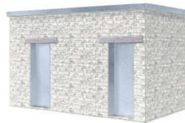
Habillage en gabions du poste de livraison (voir page 21)
